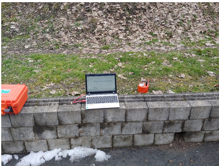
Fig. 29 - Misurazione di microtremori a stazione singola di fronte al Municipio.
