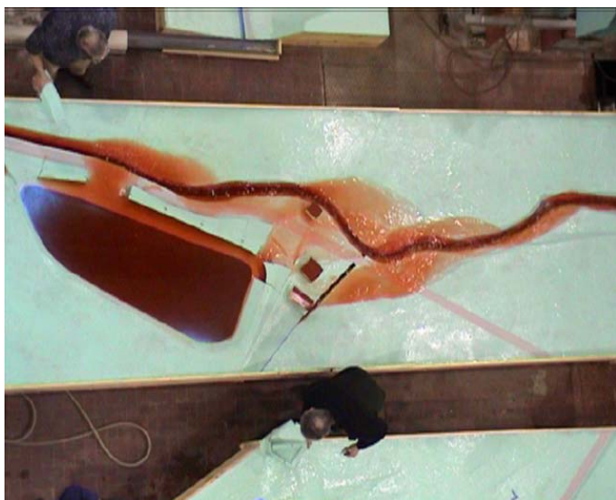
Fig. 19 – Modello idraulico (dambreak) prof. Butrera, Politecnico Torino.
